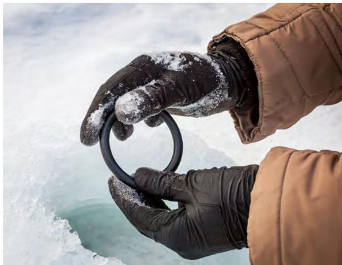
Les conditions de gel peuvent être difficiles pour les joints en élastomère. Lorsque les températures descendent en dessous des capacités du matériau, les élastomères peuvent devenir plus plastiques. Ce changement entraîne une réduction de la flexibilité, une fragilité accrue, une diminution du rebond et une diminution de la capacité à maintenir une bonne étanchéité.
